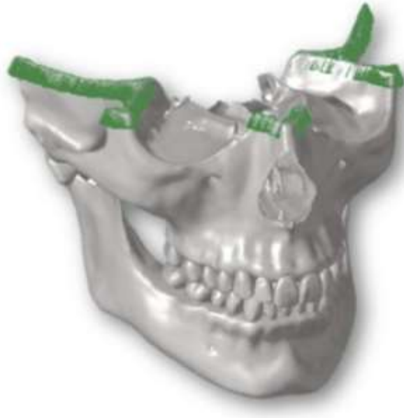
Figura 3. Elementos rígidos tipo RBE2 na porção superior da maxila, evidenciados na cor verde
