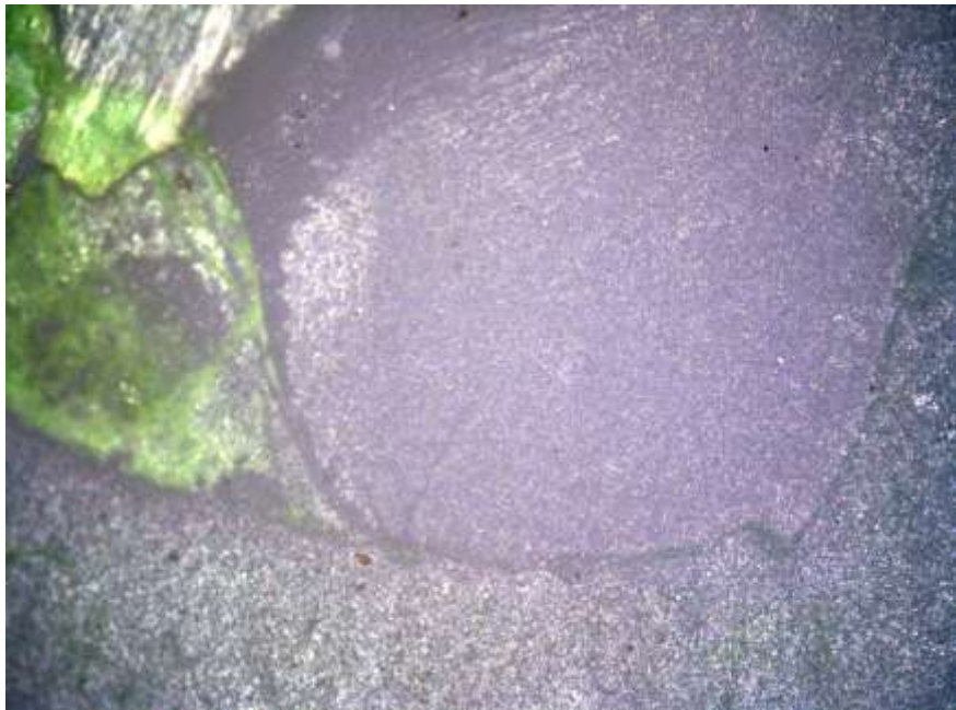
Fig. 8. Microscopia óptica do padrão de fratura classificado como adesiva de uma cimentação feita com a cerâmica jateada. As linhas da lixa de carbeto de silício não visualizas.
