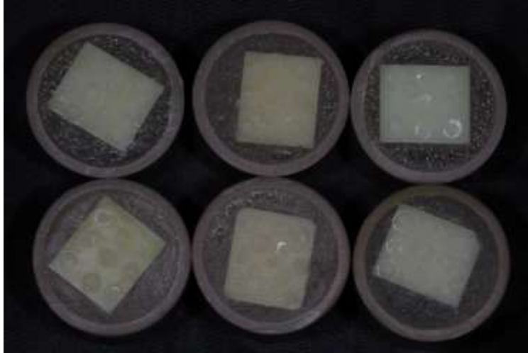
Figura 6: Corpos de prova após descolamento dos discos de resina
