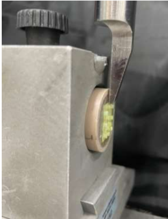
Figura 5: Ensaio mecânico na máquina de ensaios universais Emic 500
