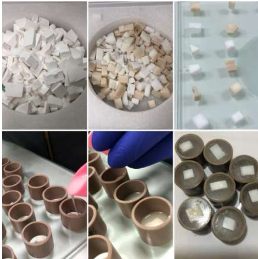
Figura 1: Fragmento de Zircônia pré-sinterizados, pós sinterização e sendo embutido em resina acrílica em uma junta de PVC
