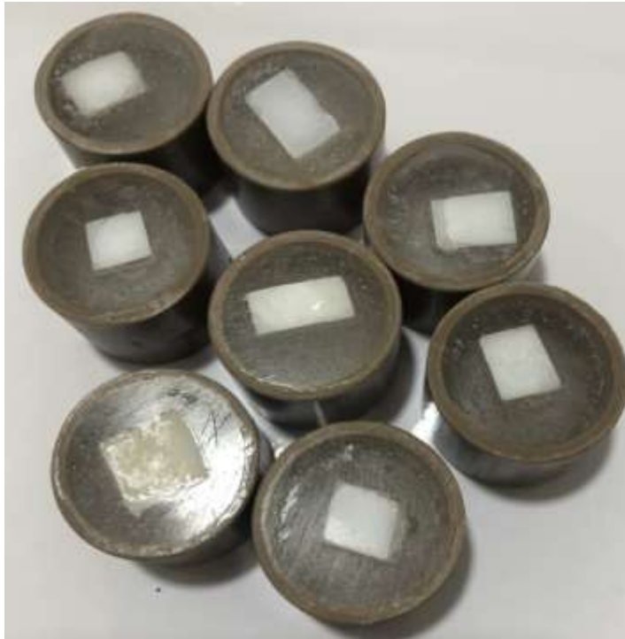
Figura 2: Fragmento de Zircônia embutido em resina acrílica em junta de PVC
