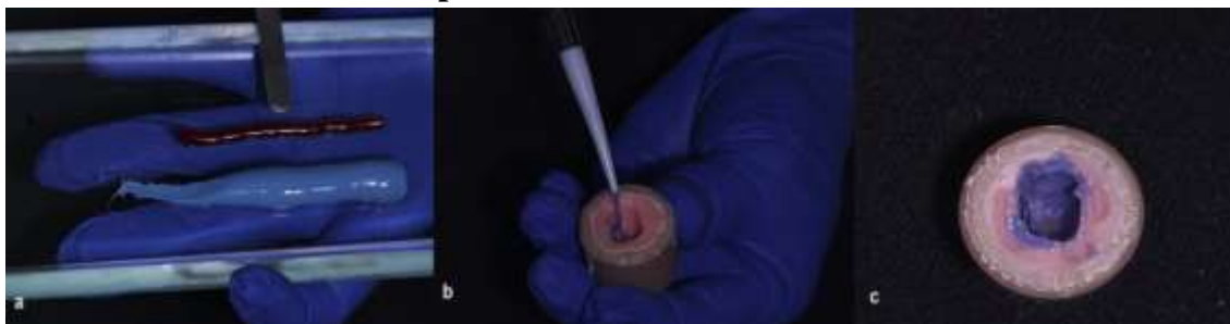
Figura 11: a) Espatulação do poliéter; b) Inserção do poliéter no PVC + Resina Jet com o auxílio de uma seringa; c) Aspecto logo após a inserção do poliéter, antecedendo o posicionamento do dente
