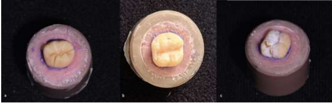
Figura 14: a) Fratura Tipo 1; b) Fratura tipo 2; c) Fratura tipo 3
