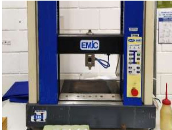
Figura 12: Máquina utilizada para o teste de compressão Emic™
