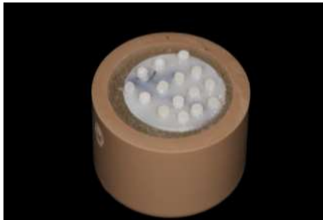
Figura 7: Amostra com todos os cilindros de resina cimentados na superfície do disco de cerâmica embutido em cilindro de PVC
