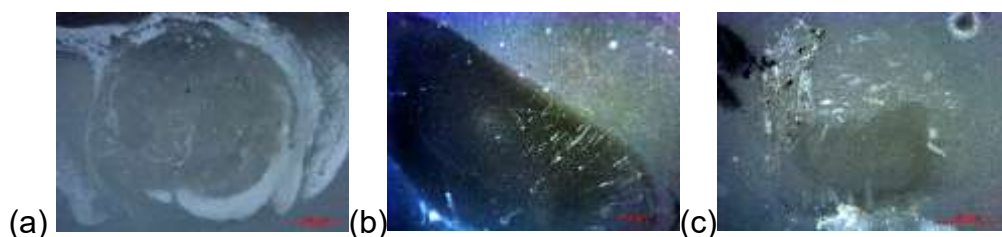
Figura 12: (a) Falha do tipo adesiva (b) Falha do tipo coesiva e (c) Falha mista
