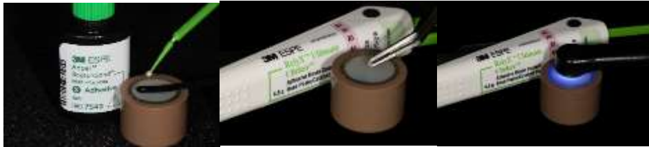
Figura 6: Sequência de aplicação de adesivo e cimentação do cilindro de resina
