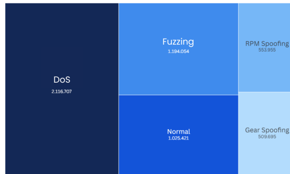
Figura 7 – Distribuição de instâncias por categoria de ataque na base consolidada antes do balanceamento (5.399.832 registros). O Denial of Service (DoS) representa a maior parcela (2.116.707 registros, 39,2%) por causa da injeção massiva de mensagens que caracteriza esse ataque. O tráfego Normal corresponde a apenas 19,0% do total, refletindo o desequilíbrio entre operação legítima e maliciosa nos cenários de teste.
