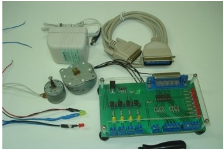
Figura 8: Interface SmartTec, cabos e motores
