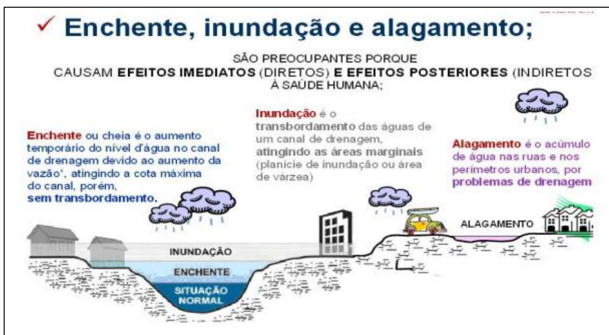
Figura 5: Perfil esquemático do processo de enchente, inundação e alagamento.
