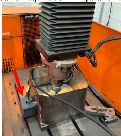
Figura 28 – Cuba instalada na máquina de EDM para usinagem com água deionizada
