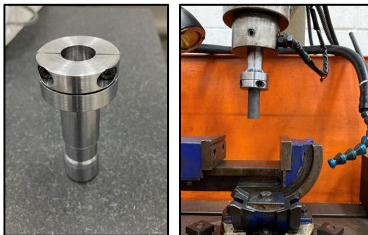
Figura 23 – Porta-Eletrodo (a) e sua montagem na máquina de EDM (b)
