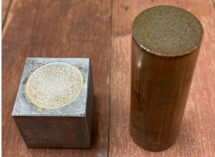
Figura 40 – Peça AISI H13 e eletrodo de cobre após EDM em água deionizada
