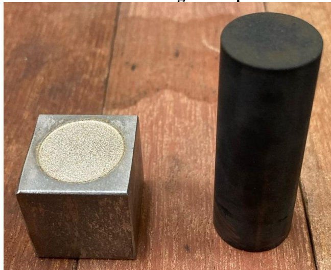
Figura 41 - Peça AISI H13 e eletrodo de grafite após EDM em água deionizada
