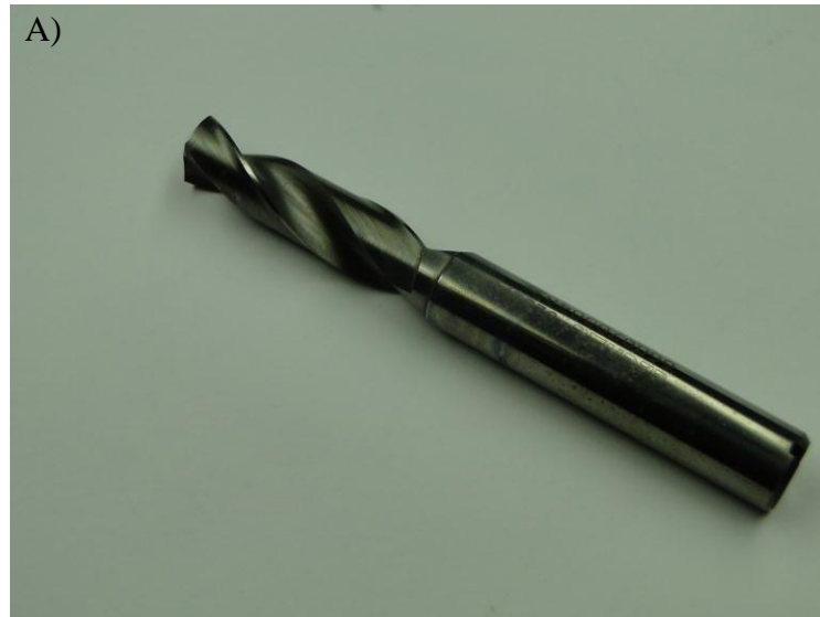
Figura 29 Brocas de metal duro. A) Sem revestimento. B) Revestida DLC.
