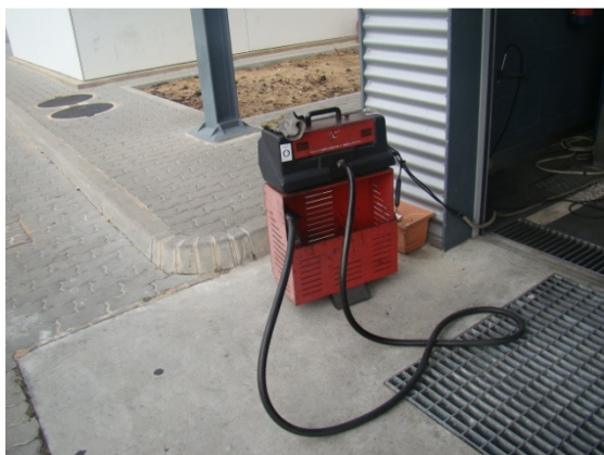
Foto: Opacímetro (emissões Diesel). Fotos do autor.
