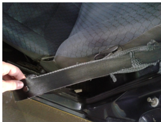
Foto: Cinto danificado. Bassoli, 2011.
