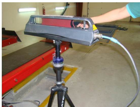
Foto: Sistema de medição de alinhamento da estrutura do monobloco. Fotos do autor.
