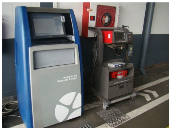
Foto: Analisador de gases (emissões Otto). Fotos do autor.
