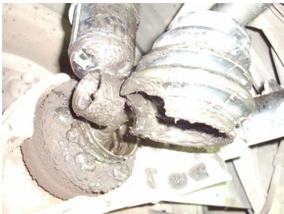
Foto: Rompimento de amortecedor e homocinética. Fotos do autor.
