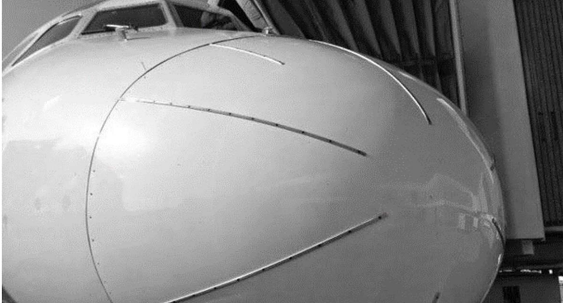
Figura 15 - Lightning diverters instalados no radome de uma aeronave
