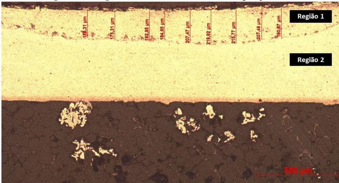
Figura 49 - Região abaixo do dano no CP2. Ampliação de 50x
