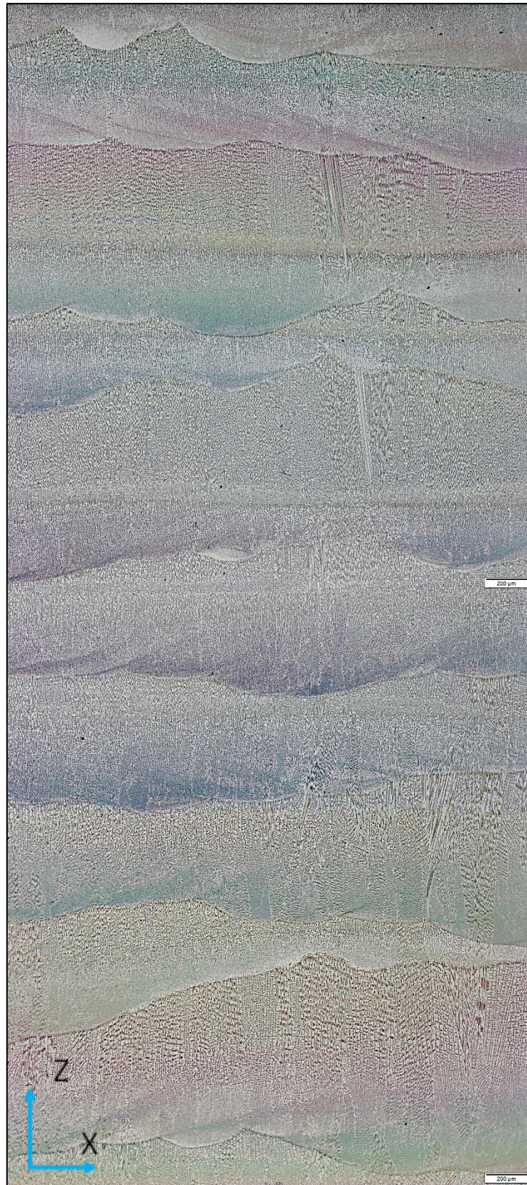
Figura 18 - Macrografia da seção longitudinal da pré-forma com múltiplas camadas de deposição de Inconel 625. MO: 50x
