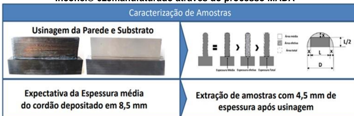
Figura 11 - Componente constituído da barra usinada de aço carbono e parede Inconel® 625manufaturado através do processo MADA
