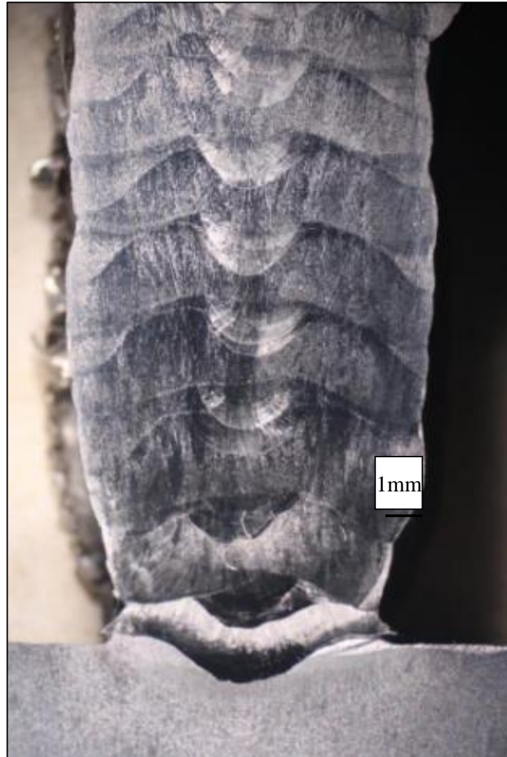
Figura 17 - Imagem da macroestrutura com evidência da disposição dos cordões depositados e da interface da barra com a pré-forma
