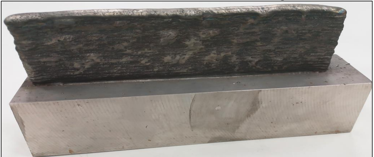
Figura 14 - Imagem do bloco retangular com parede de espessura média vertical de 8,5 mm em Inconel® 625 antes da usinagem
