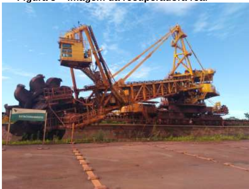
Figura 5 – Imagem da recuperadora real
