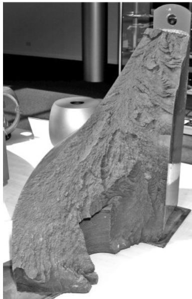
Figura 10 – Imagem de peça de vaso de pressão sob falha por fratura frágil
