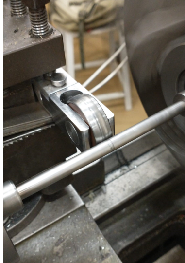
Figura 43 – Detalhe da aplicação da carga
