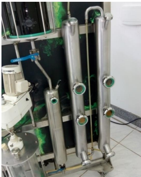
Figura 21: Purificação através da coluna de resina de troca iônica
