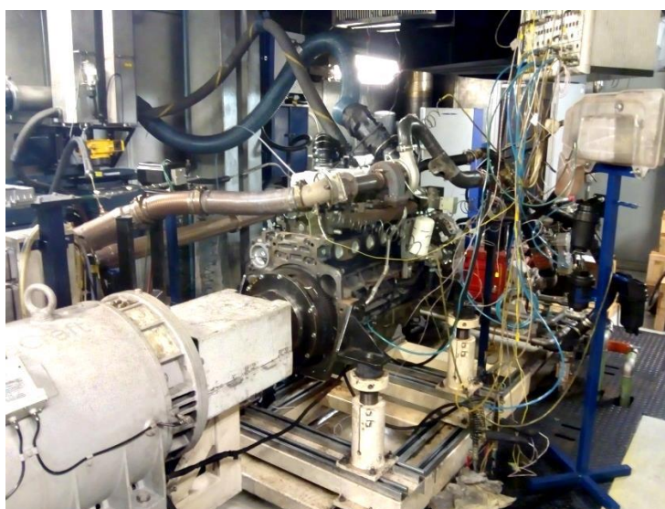
Figura 26: Motor FPT Industrial N67 instalado no dinamômetro
