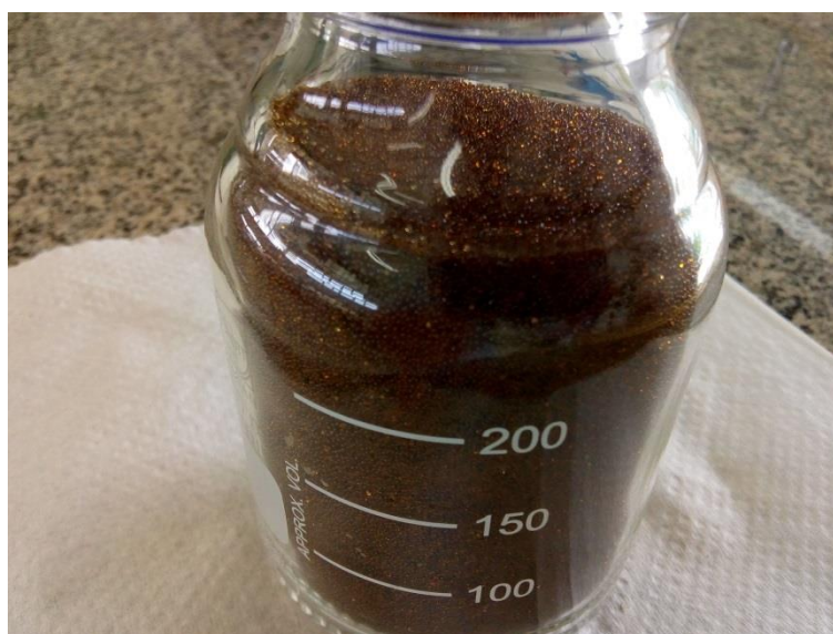
Figura 22: Resina utilizada para purificação do biodiesel
