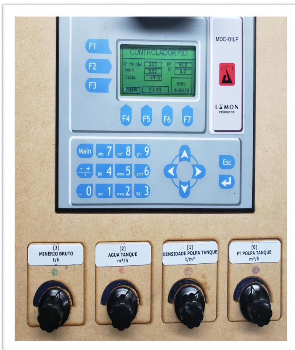
Figura 28 – Valores de Edição: Parâmetros do PID
