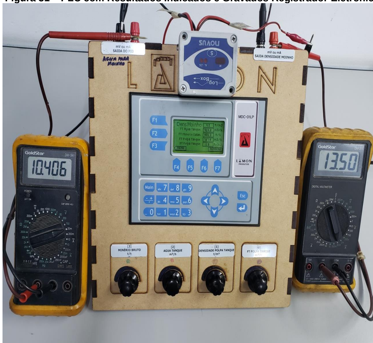
Figura 31 – PLC com Resultados Indicados e Gravados Registrador Eletrônico
