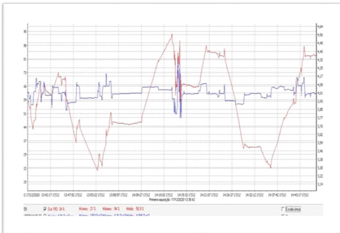
Figura 34 - Registro gráfico água controlada para moinho e densidade interna
