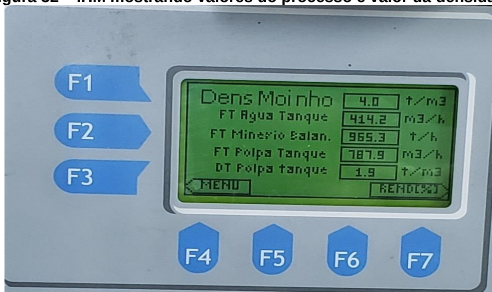
Figura 32 – IHM mostrando valores do processo e valor da densidade
