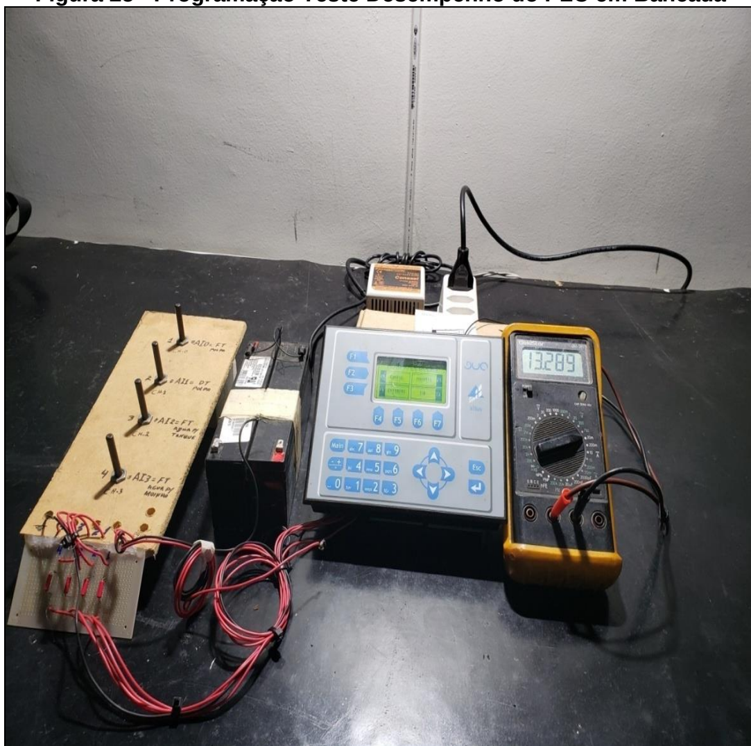
Figura 25 - Programação Teste Desempenho do PLC em Bancada
