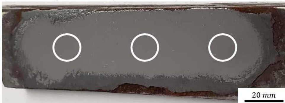
Figura 38 – Esquemático dos pontos de medição para o teste eletroquímico
