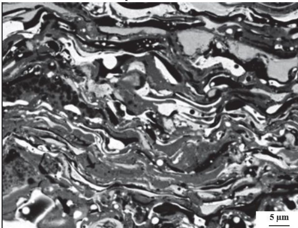
Figura 15 – Microscopia óptica do revestimento depositado através do processo de aspersão térmica
