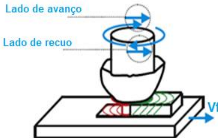
Figura 16 – Lado de avanço e recuo da ferramenta (haste consumível)
