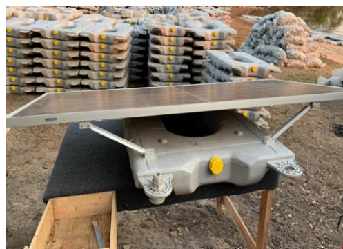
Figura 36 - Conjunto de flutuadores da UFVf em Grão Mogol com os módulos fotovoltaicos
