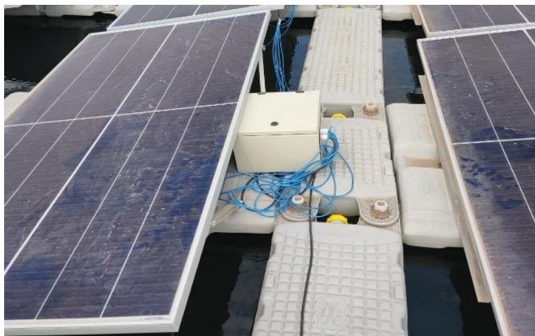
Figura 38 - Sistema auxiliar de aquisição de dados referente à temperatura de operação
