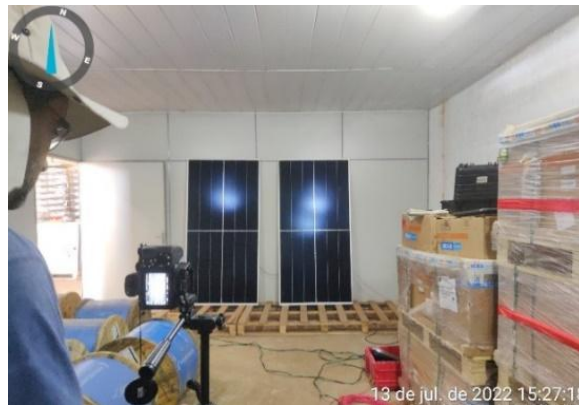
Figura 27 - Módulo em ensaios de eletroluminescência – EL
