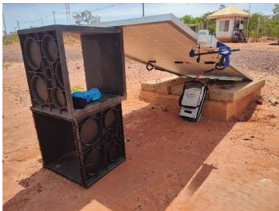
Figura 48 – Módulo fotovoltaico sob ensaios elétricos para avaliação da LID
