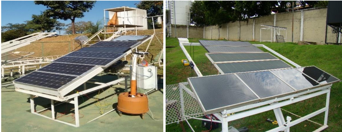
Figura 25 - Bancadas para realização de ensaios em módulos fotovoltaicos
