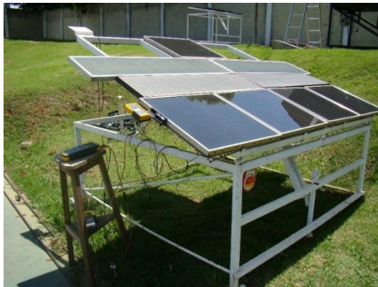
Figura 28 - Módulos em filme finos selecionados para ensaios elétricos e térmicos
