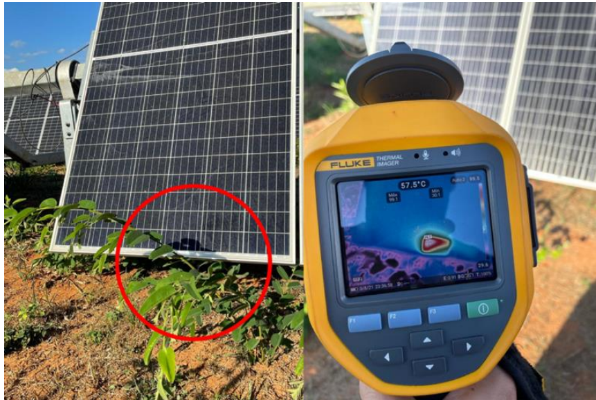
Figura 47. Pontos quentes causados pela vegetação local – UFV Três Marias
