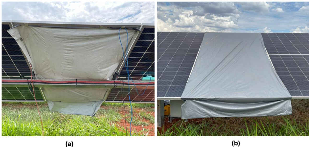
Figura 42. Procedimento curva IxV da face frontal (a) e posterior (b) do módulo FV bifacial
