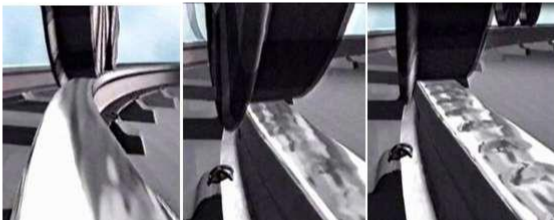
Figura 12 - Evolução da corrugação em trilho em função do contato com a roda
