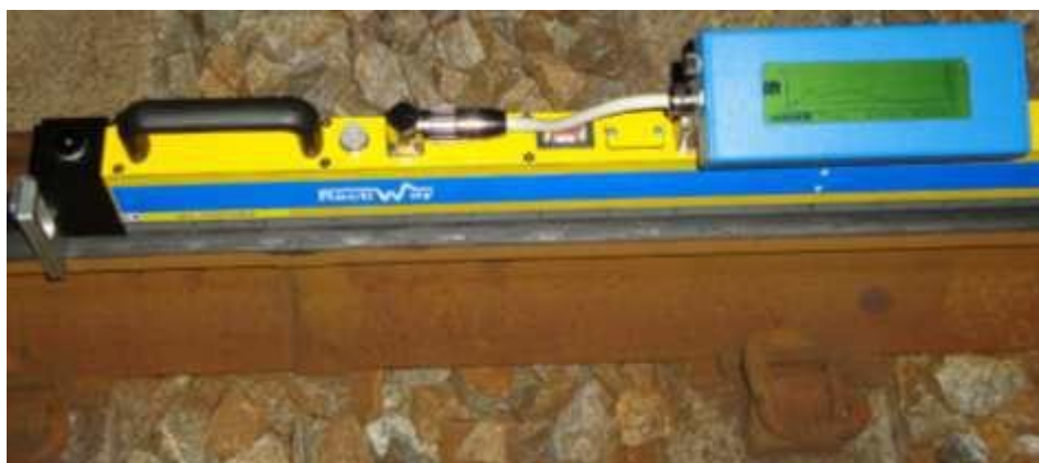
Foto 25 – Tela do equipamento Rectiway
