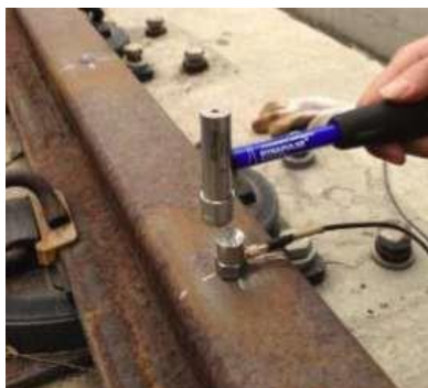
Foto 5: Teste de excitação do trilho
