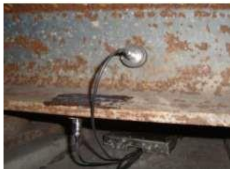
Foto 6: Acelerômetro no trilho
