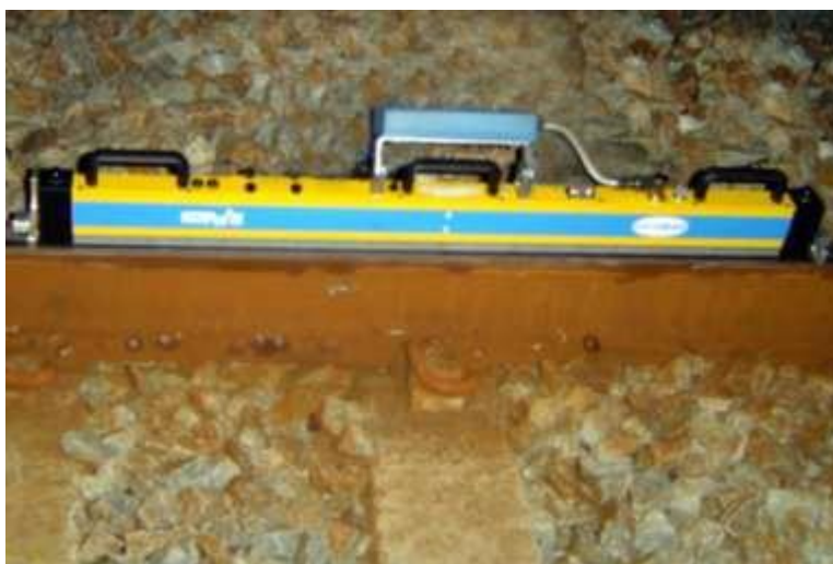
Foto 24 - Régua de medição de corrugação Rectiway
