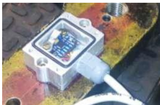
Foto 27 – Montagem do acelerômetro
