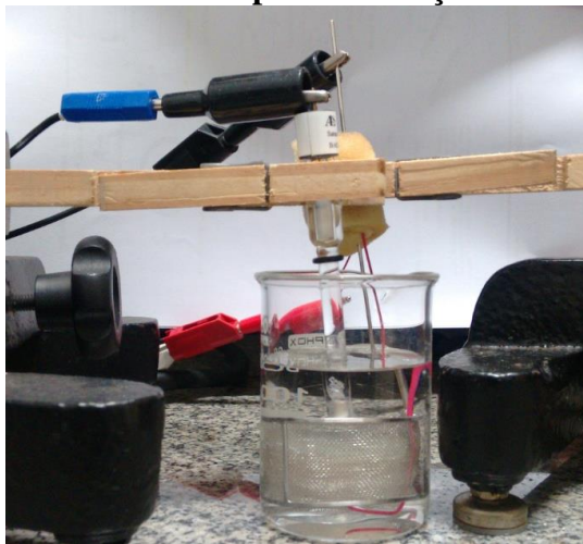
Figura 50 Montagem dos eletrodos para realização dos ensaios eletroquímicos
