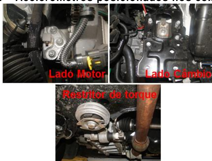
Figura 52 – Acelerômetros posicionados nos coxins motor
