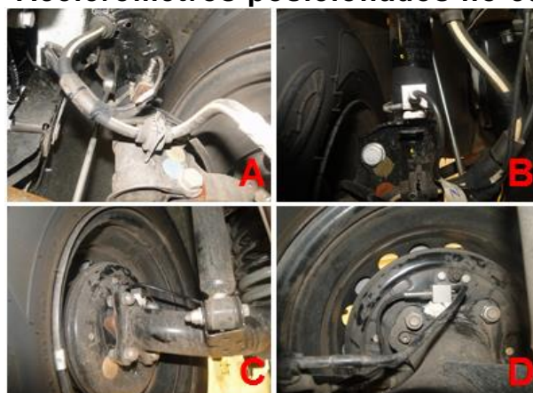
Figura 51 – Acelerômetros posicionados no cubo de roda
