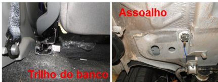
Figura 53 – Acelerômetros posicionados no trilho do banco e no assoalho
