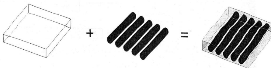
Figura 1 - Montagem básica de um compósito: união de uma base com reforços estruturais
