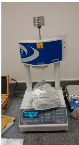
Figura 32 - Foto da máquina usada no ensaio de fluidez do polipropileno PX2507
