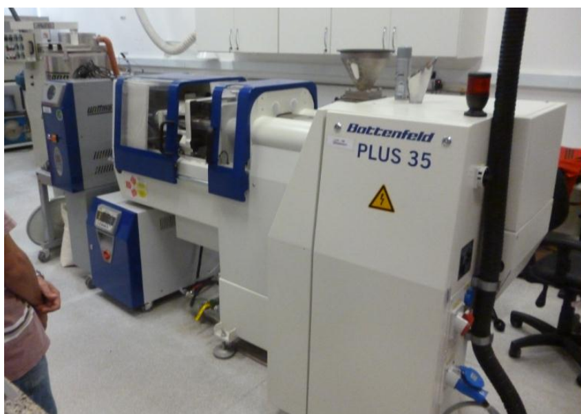
Figura 21 - Foto da injetora onde os corpos de prova foram feitos
