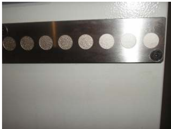
Figura 33 – Régua demonstrativa de rugosidade da Máquina de Eletroerosão por penetração ENGEMAC 440 NC.
