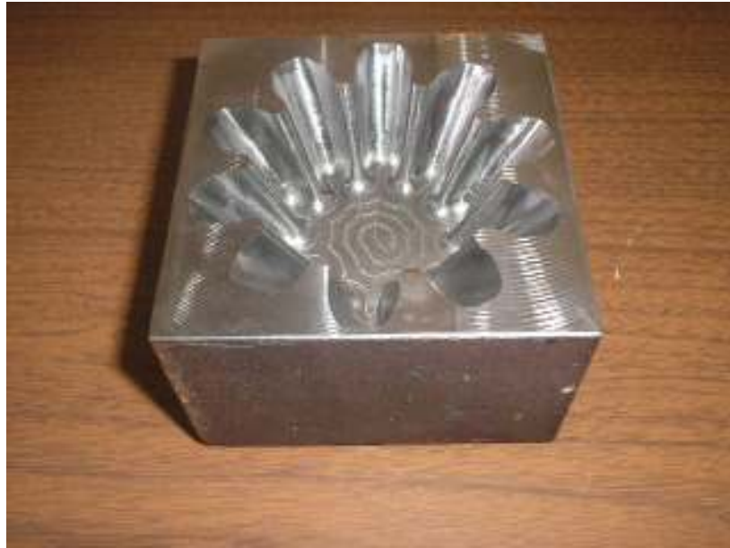
Figura 2 – Matriz fabricada pelo processo de usinagem, em aço AISI H13.
