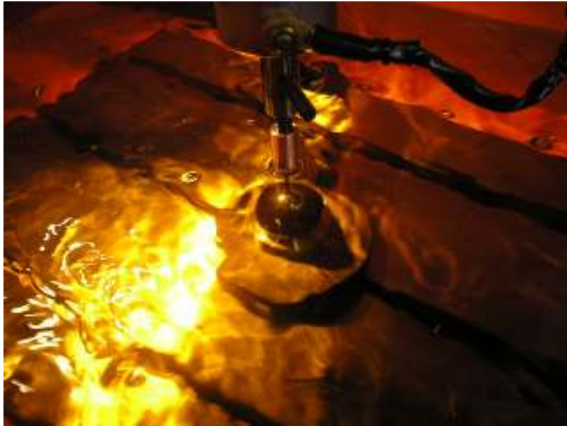
Figura 22 – Uso do fluido dielétrico em EDM.
