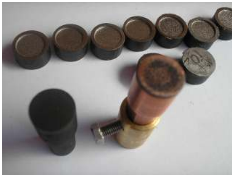
Figura 21 – Eletrodos-ferramenta de cobre e grafite utilizados em EDM.
