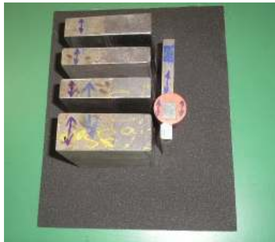
Figura 24 – Material retirado do bloco prismático do aço AISI H13 para identificar o sentido de laminação.
