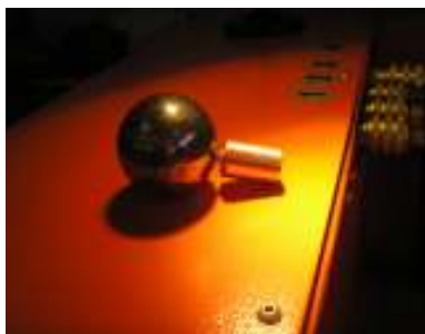
Figura 16 – Furo com diâmetro de 2mm x 40mm de profundidade, realizado por EDM, em uma esfera de rolamento com dureza de 740 HV.
