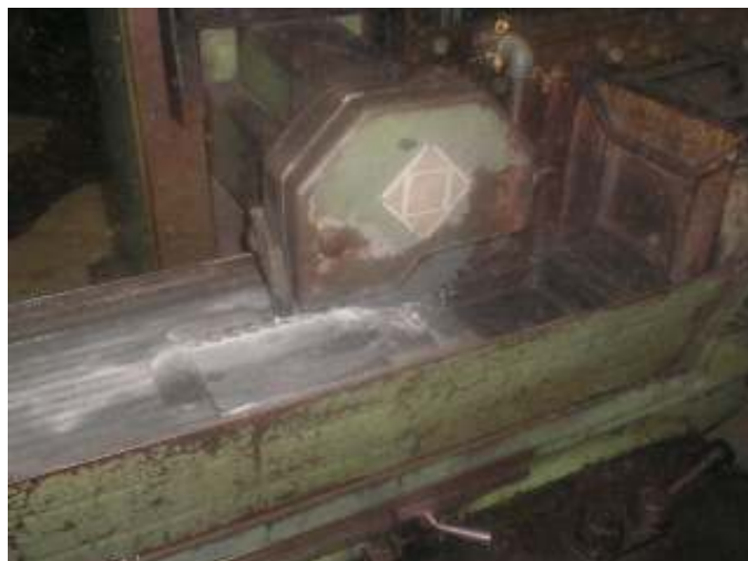
Figura 28 – Processo de retificação plana tangencial. Foto retirada no Laboratório de Usinagem do Centro Federal de Educação Tecnológica de Minas Gerais.
