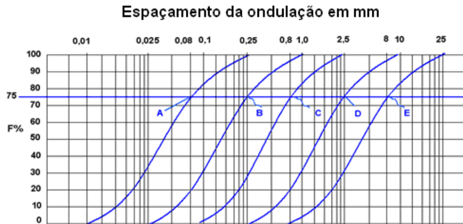
Figura 2.9 - Ação do filtro ISO 2CR no perfil de ondulação (Taylor Robson, 2000).
