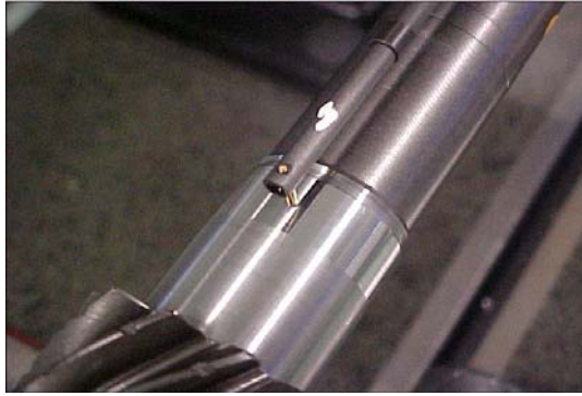
Figura 3.8 - Medição de textura superficial no ponto máximo (vista de cima).
