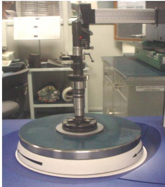
Figura 3.3 - Processo de alinhamento e nivelamento da peça.
