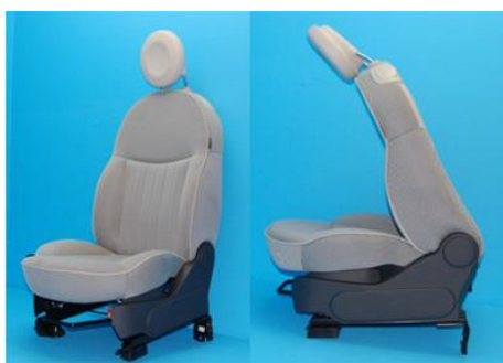
Figura 18: Demonstração do rebatimento do encosto
