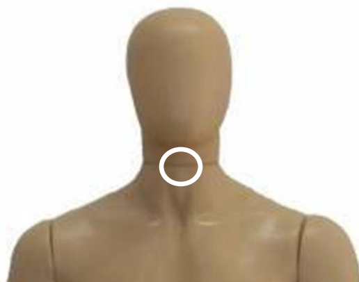
Figura 42: Local de fixação do acelerômetro no manequim Fonte: Fotografia do autor
