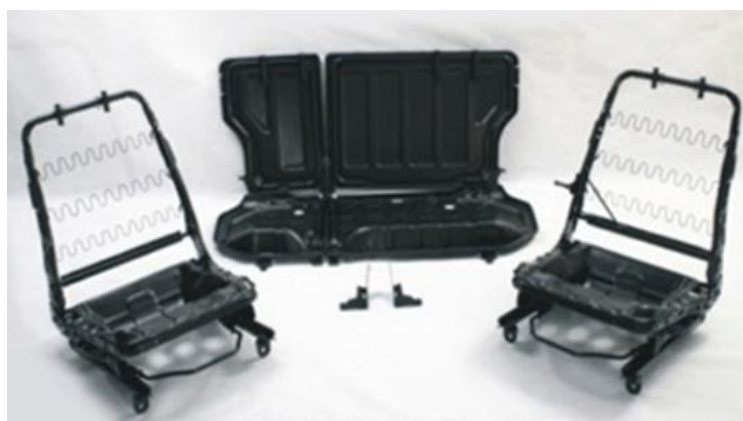
Figura 12: Estruturas de banco dianteira e traseira
