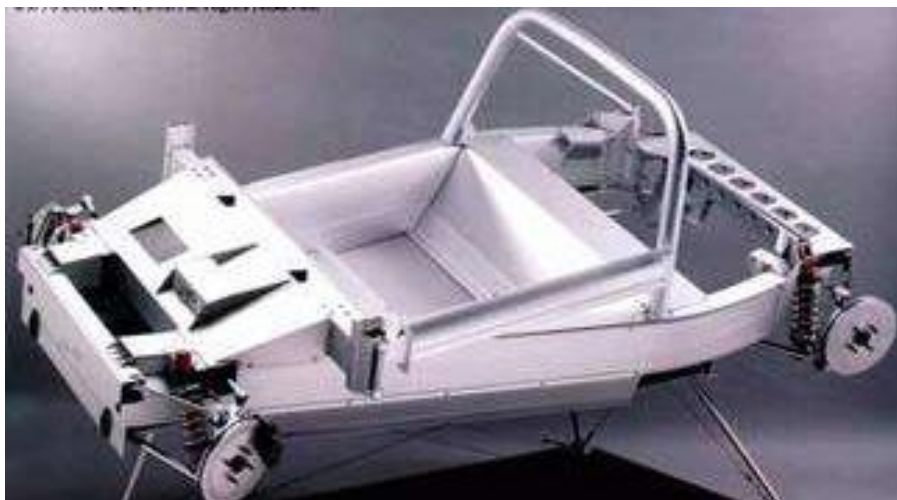
Figura 5: Estrutura de plataforma
