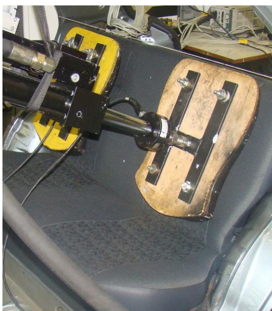
Figura 58: Bancada de prova simulando dois ocupantes no encosto do banco posterior
