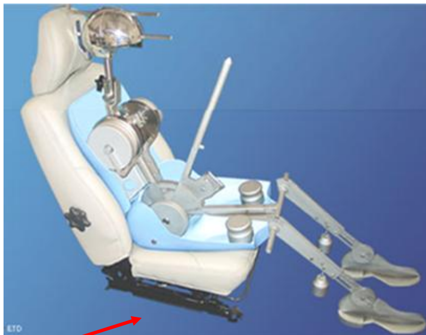
Figura 38: Manequim tridimensional SAE J826 mostrando o pino de medição do ponto H
