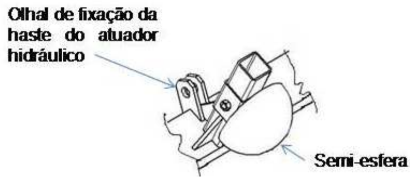
Figura 3.20 – Olhal de fixação da haste do atuador hidráulico - Dispositivo semi-esfera
