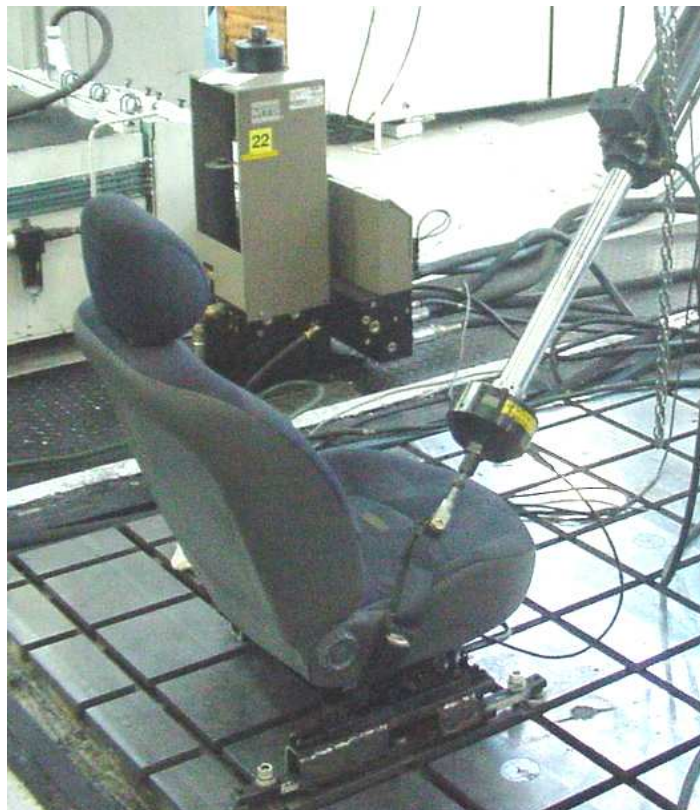
Figura 3.2 – Banco com a Estrutura ED1- Fixado à bancada de teste para ensaio de ancoragem
