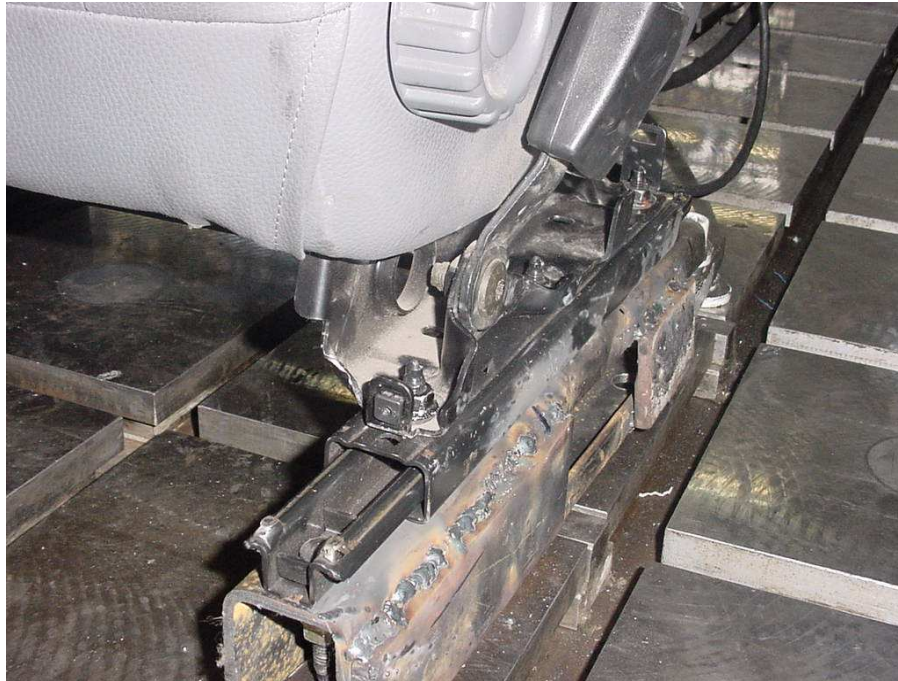
Figura 4.4 – Banco estrutura ED1 – Antes do ensaio de ancoragem do fecho do cinto
