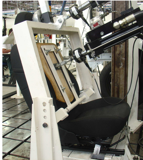
Figura 3.17 – Base de fixação da estrutura do banco - Ensaio estático
