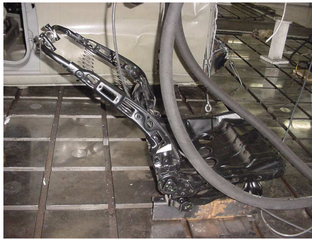
Figura 4.6 – Ensaio de cedimento da estrutura do encosto banco EDC1- Imagem da estrutura após o ensaio
