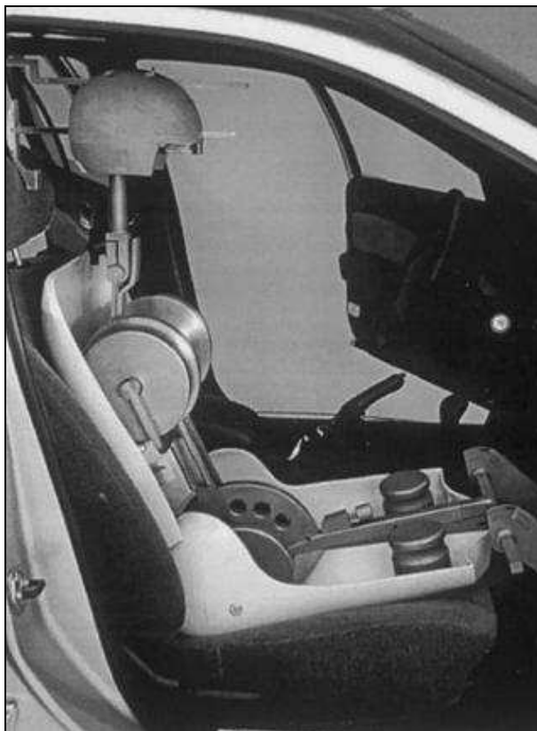
Figura 2.18 – Manequim SAE, com cabeça para mensurar as distâncias verticais e horizontais relativas ao apoio de cabeça. (O'NEILL,2000)
