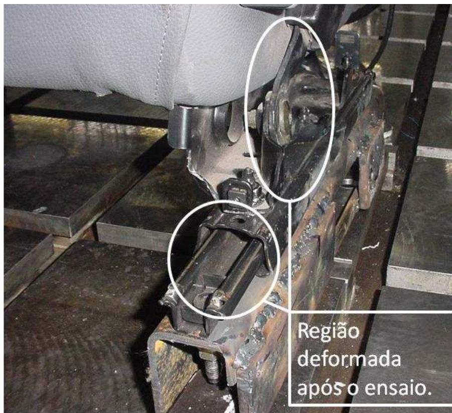
Figura 4.5 – Banco estrutura ED1 - Após o ensaio de ancoragem do fecho do cinto
