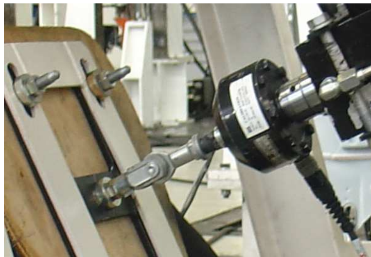
Figura 3.21 – Detalhe do ponto de fixação do dispositivo da haste do atuador hidráulico
