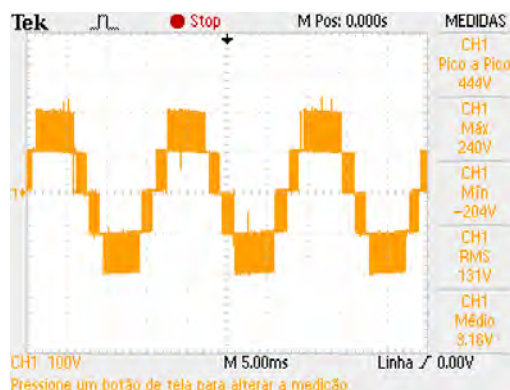
Figura 80 – Tensão fase-fase V_{ab} (Comparador de 2-níveis)
