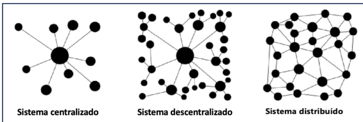
Figura 1 - Demonstração gráfica de um sistema centralizado, descentralizado e distribuído 1
