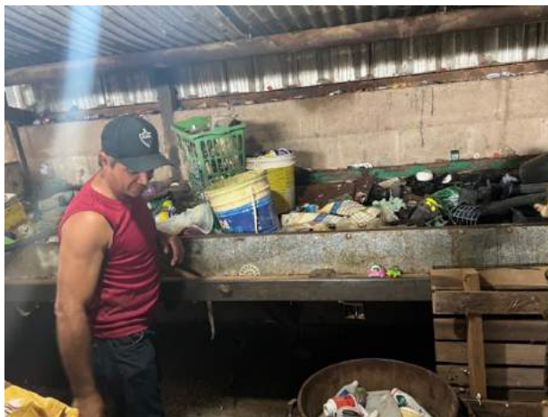
Figura 32 - Área abaixo do silo onde é feita a separação do material, ou área de triagem
