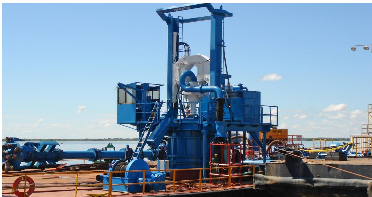
Figura 64 - Perfuratriz hidráulica rotação reversa, Wirth
