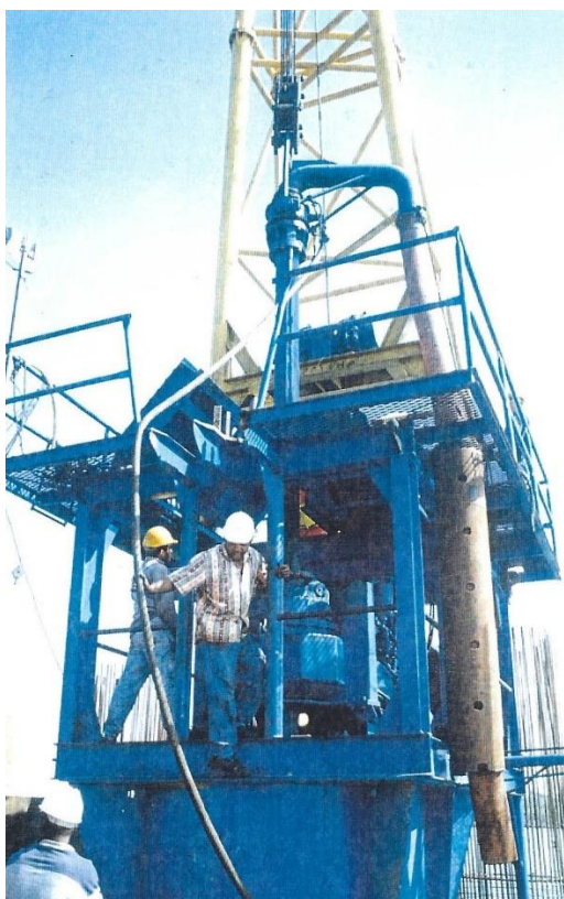
Figura 71 - Equipamento de perfuração Wirth montado para operação
