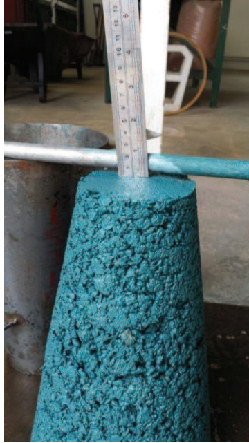
Figura 4 – Teste do Slump
