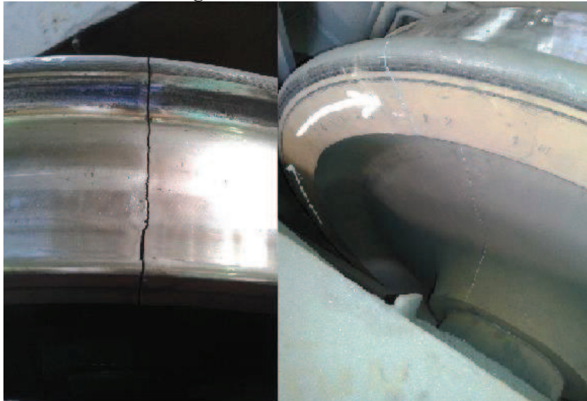
Figura 8 - Fratura radial da roda
