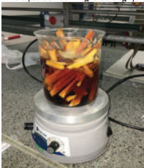
Figura 1 - Extração do licor negro do bagaço de cana de açúcar
