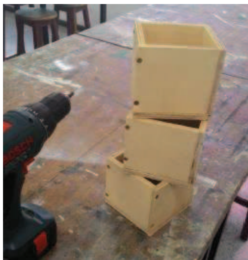
Figura 3 - Fôrmas cúbicas finalizadas
