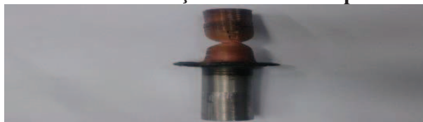
Figura 7 - Solda dissimilar de aço 1020 e cobre após o ensaio de tração
