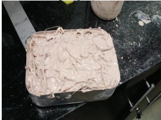
Figura 3 - compósito formado pela junção da madeira e do cimento sorel
