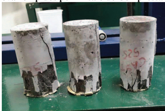
Figura 5 - Corpos de Prova rompidos por Ensaio de Compressão Axial
