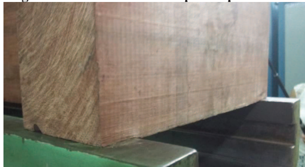
Figura 5 - Esmagamento da madeira dos apoios após início do carregamento
