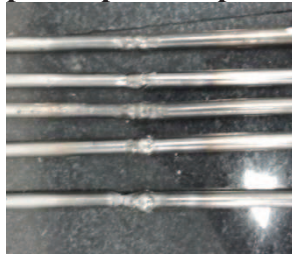
Figura 6 - Corpos de provas após união com solda
