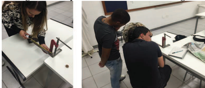
Figura 2 - Experimento da deflexão de vigas
