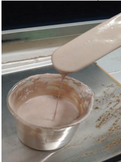
Figura 2 - Cimento sorel dissolvido em Solução de cloreto de magnésio
