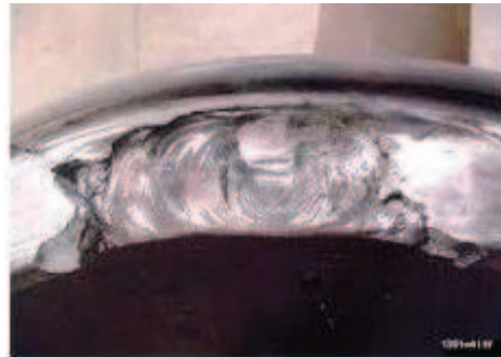
Figura 6 - Shattered rim- aro da roda despedaçado
