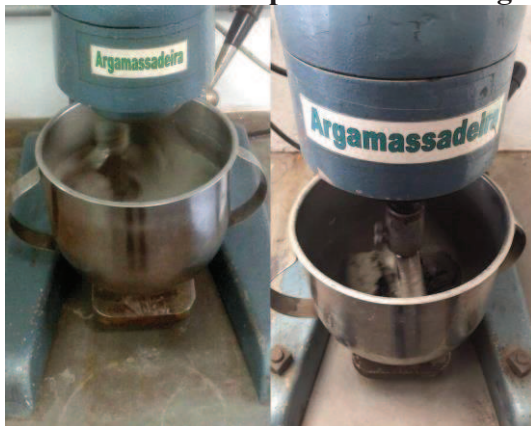
Figura 3 - Concreto sendo produzido na Argamassadeira
