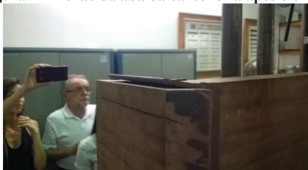
Figura 4 - Flexão da aba da cantoneira após o ensaio
