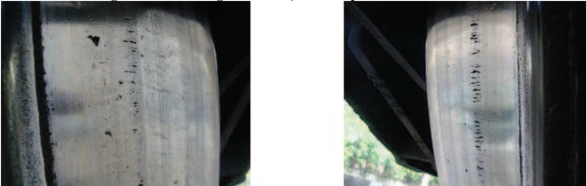
Figura 5 - Shelling - Escamação da superfície de rolamento
