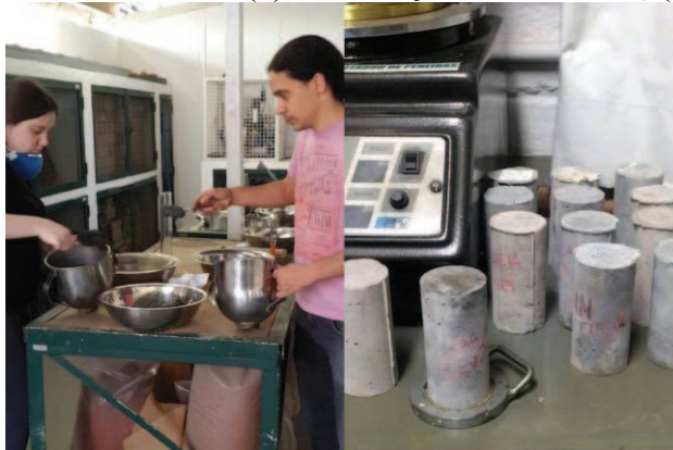
Figura 04 - Concreto Pós-reativo - (a) Fabricação do concreto, (b) Corpos de Prova
