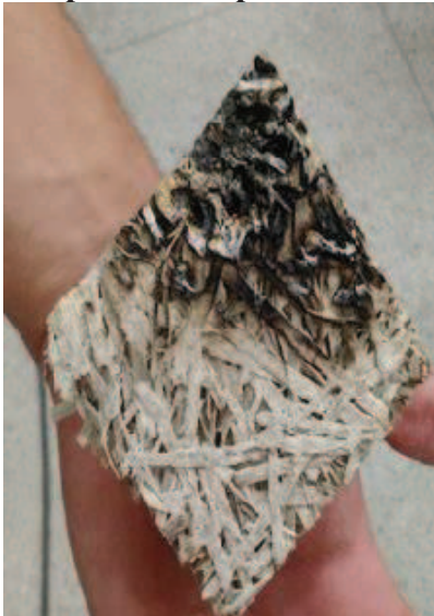
Figura 6 - Compósito exposto à temperatura de 200 C° por 5 minutos
