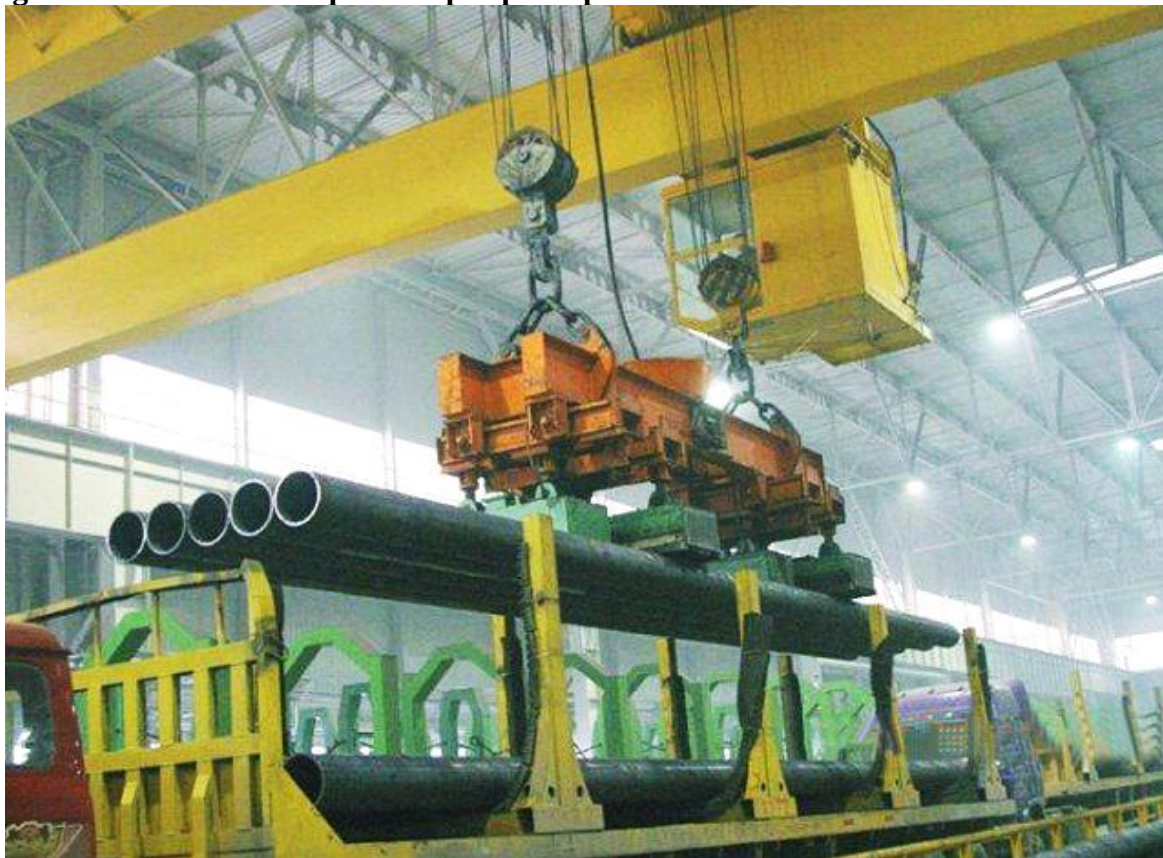
Figura 1: Ponte Rolante que atua por princípio de eletroímã
