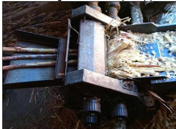
Figura 4 – Carregamento do caminhão (a) e processo de moagem da cana de açúcar (b)
