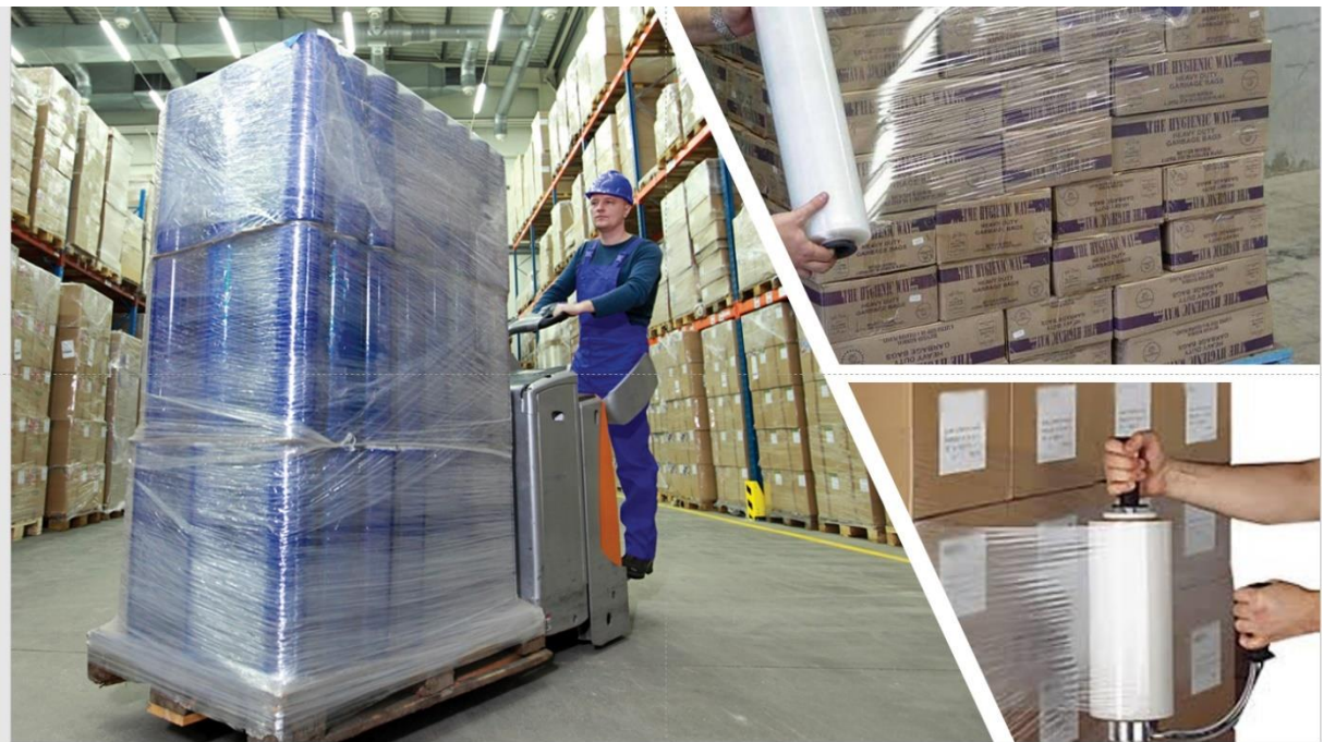
Figura 1: Aplicação do filme stretch e palete embalado com o filme. Fonte: Adaptado de Estik (2023)
