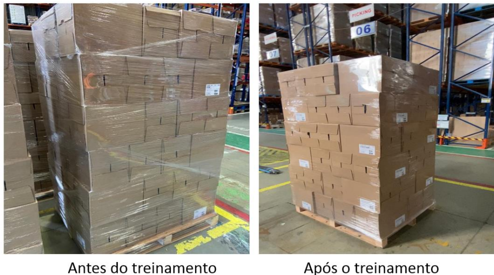
Figura 7: Comparação visual entre paletes envelopados antes e depois do treinamento. Fonte: Resultados da pesquisa. Elaborado pelo autor.
