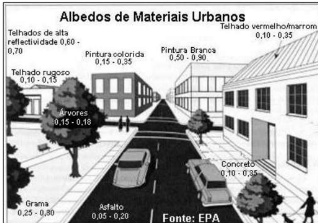
Figura 02 – Albedos de Materiais Urbanos
