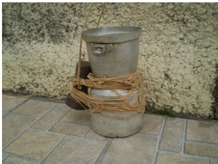
Figura 23 – Amostrador de Carga de Leito Improvisado; Fonte: Acervo do autor, 2013.
