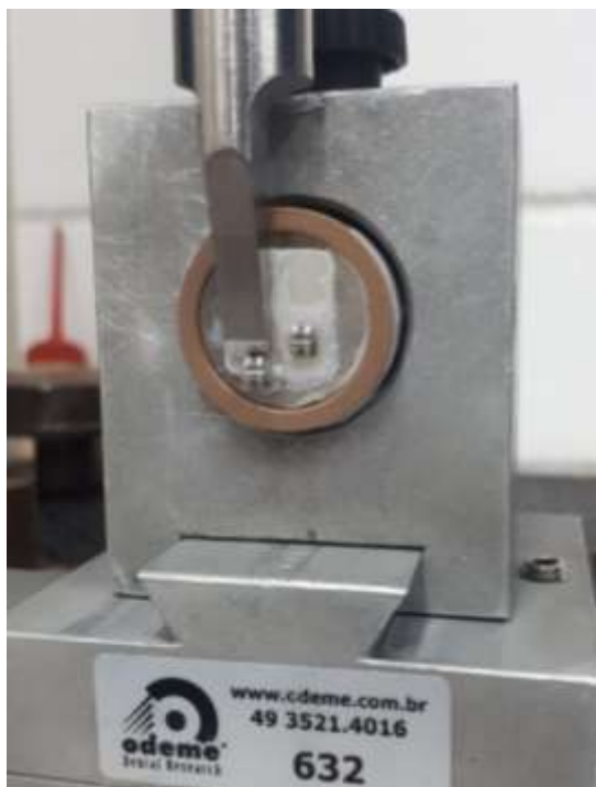
Figura 3: Corpo de prova sendo submetido à teste de resistência ao cisalhamento
