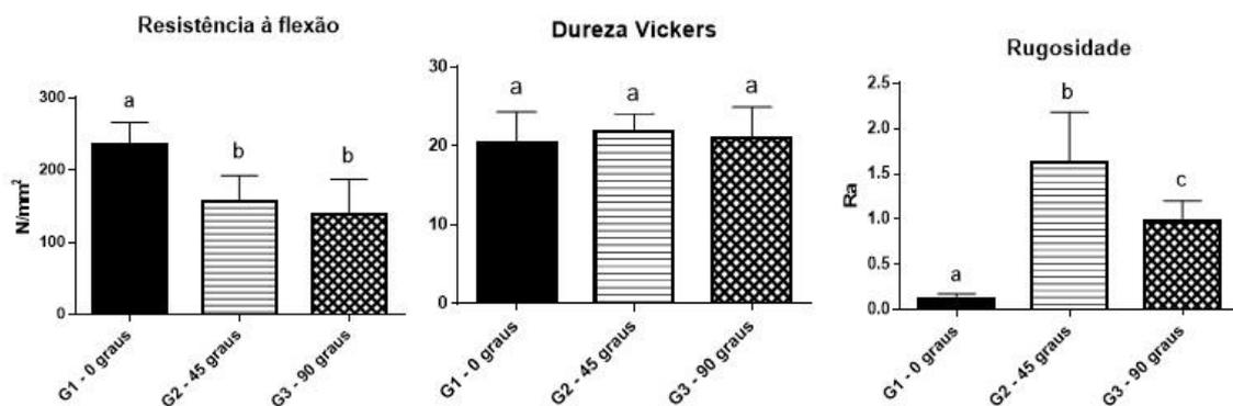
**Figura 3.** Resistência à flexão (N/mm<sup>2</sup>), dureza Vickers (hv) e rugosidade aritmética (Ra) dos grupos 1, 2 e 3. Barras com as mesmas letras não são estatisticamente diferentes ( $p > 5\%$ ) (ANOVA seguido por teste de Tukey).
