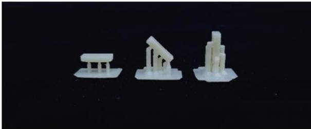
**Figura 2.** Fotografia dos corpos de prova sobre a base após impressão. Camadas impressas a 0, 45 e 90 graus em relação a base de impressão.
