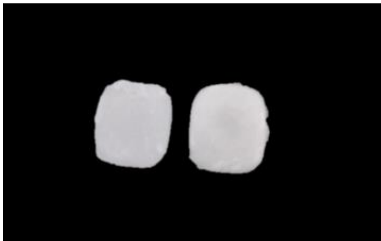
Figura 2: Discos de cerâmica confeccionados pelo CAD/CAM
