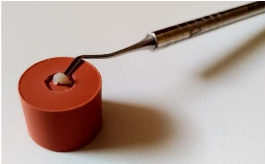
Figura 3: Acomodação da resina composta na matriz de silicone com auxílio da espátula de resina
