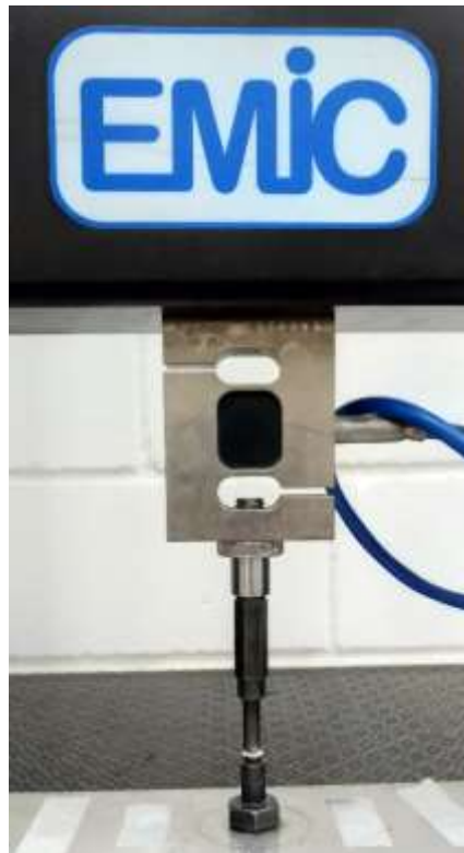
Figura 10: Dispositivo acoplado à máquina de ensaio e disco apoiado
