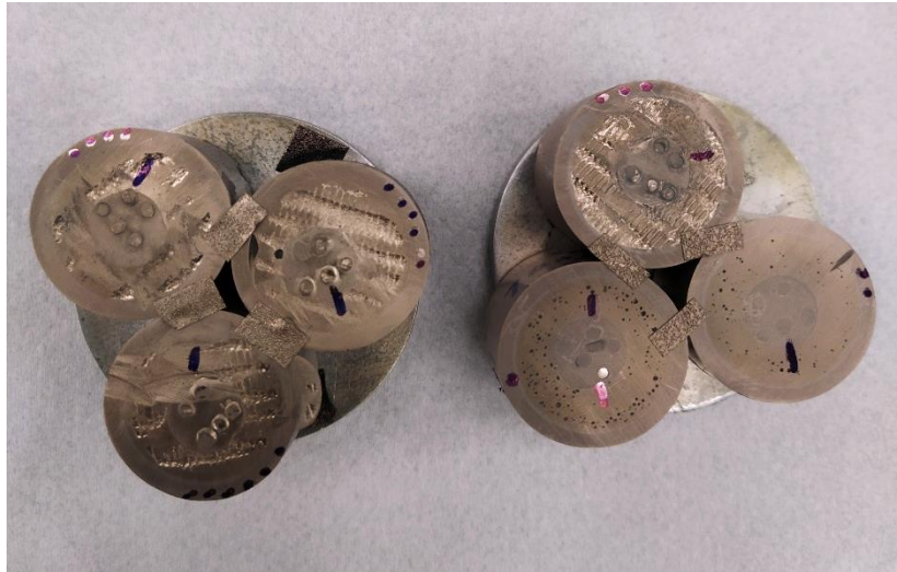
Figura 8: Amostras recobertas por fina camada de ouro
