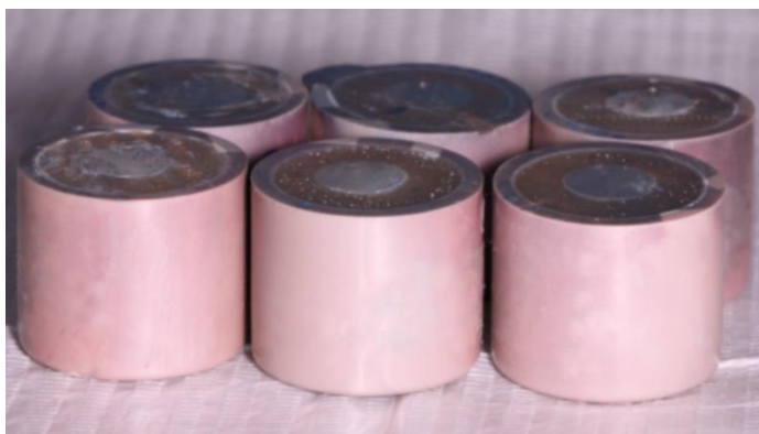
Figura 1: Juntas de PVC utilizando resina acrílica autopolimerizável e os discos de resina na região central
