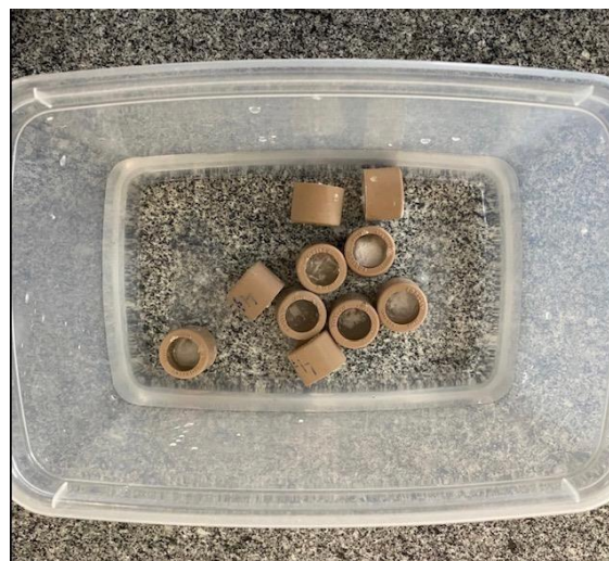
Figura 5: Armazenamento água destilada por 24h
