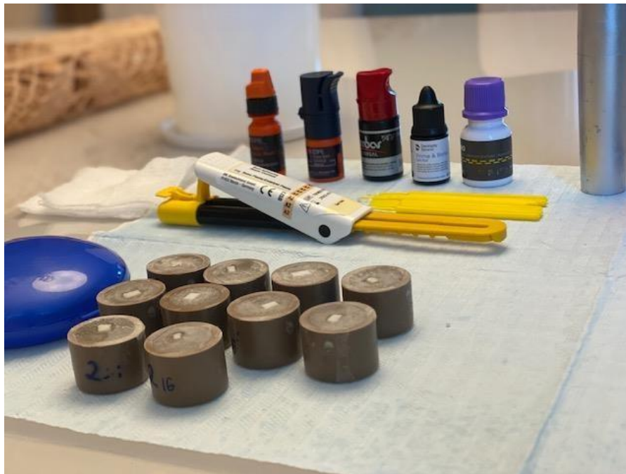
Figura 4: Cimentação cilindros de resina à zircônia
