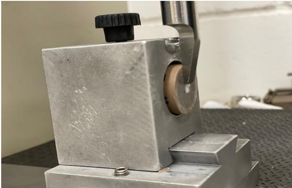
Figura 7: Dispositivo para ensaio ao cisalhamento
