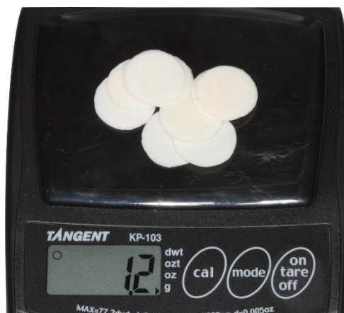
Figura 3: Peso inicial dos discos em cera para injeção
