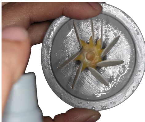
Figura 12: Aplicação do redutor de tensão superficial
