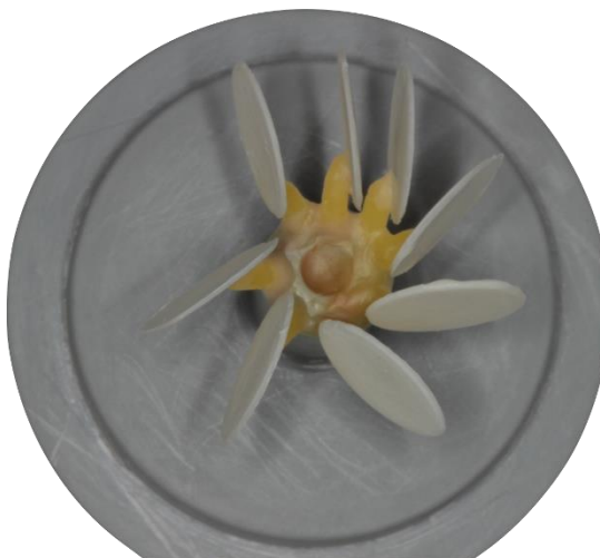
Figura 9: Fixação do disco no anel de injeção
