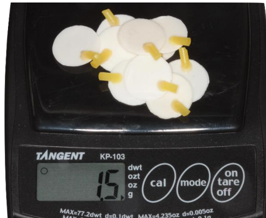
Figura 5: Peso dos discos em cera após a fixação do sprue para injeção
