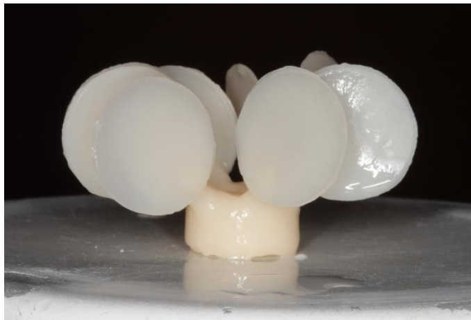
Figura 22: Cerâmica após a injeção e limpeza
