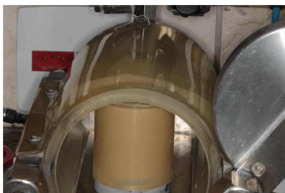
Figura 15: Dispositivo à vácuo para presa do revestimento
