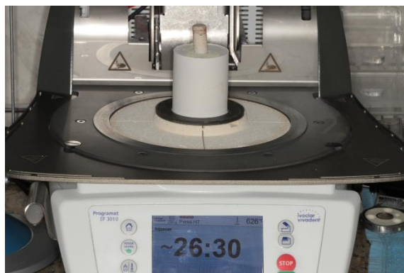
Figura 18: Forno programado para realizar a injeção
