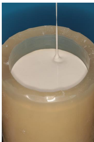
Figura 14: Inserção do revestimento no anel
