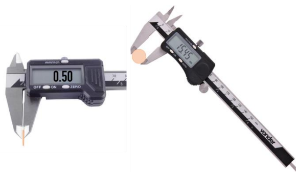
Figura 25: Medição da espessura e diâmetro dos corpos de prova
