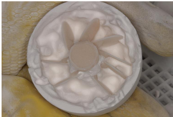
Figura 21: Remoção parcial do revestimento
