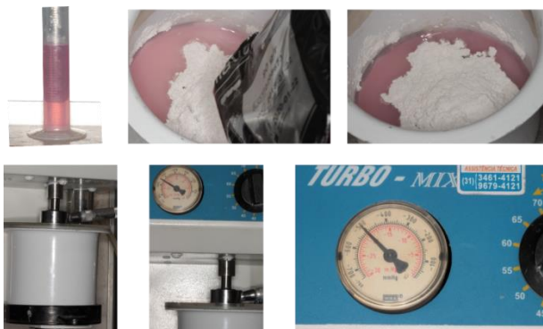
Figura 13: Processo de manipulação do revestimento
