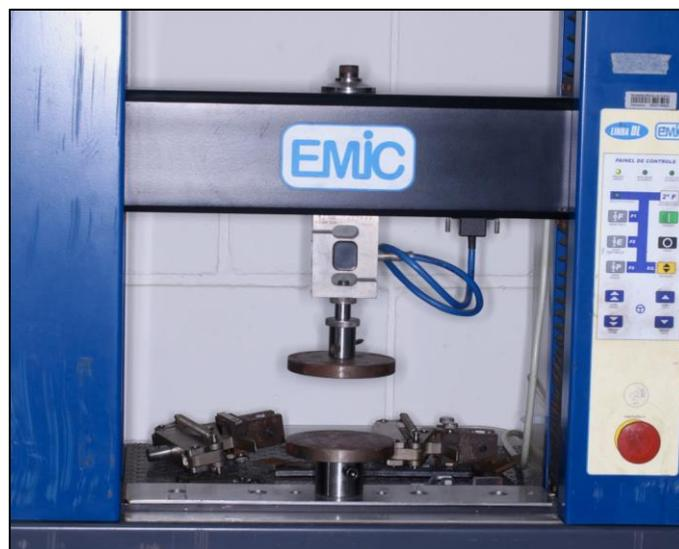
**Figura 5 – Máquina de ensaio universal**
