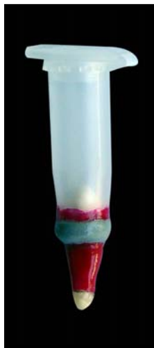
FIGURA 14: resina Epóxi na junção tubo-dente
