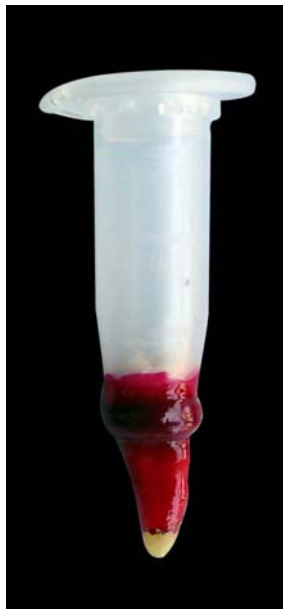
FIGURA 15: resultado final da impermeabilização dos espécimes
