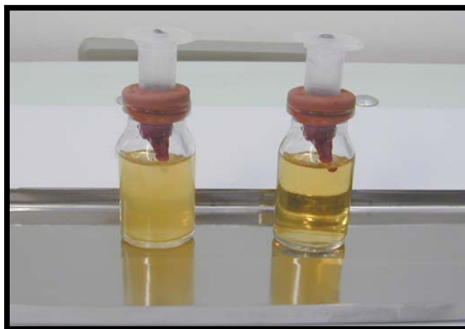
FIGURA 20: diferença entre meio de cultura contaminado e não contaminado.
