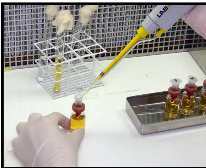
FIGURA 19: Inoculação microbiana dos espécimes
