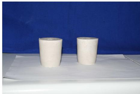
Figura 12: Molde de revestimento
