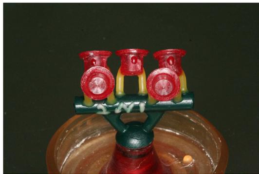
Figura 10: Casquetes fixados na base formadora de cadinho
