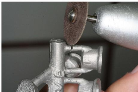
Figura 15: Remoção da canalização.
