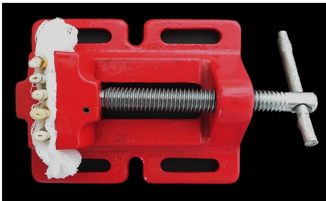
Figura 5: Espécimes fixados em morsa
