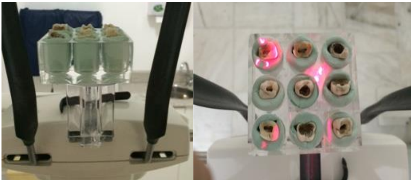
Figura 2. Padronização do exame TCFC: plataforma do tomógrafo com a placa de acrílico
